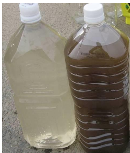
除染水 モミガラ浄化後(左)、モミガラ浄化前(右)
